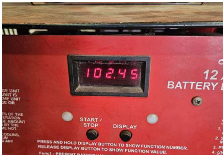
75A 방전 Test 결과 102.4분 [Spec. 134분 대비 76%]
