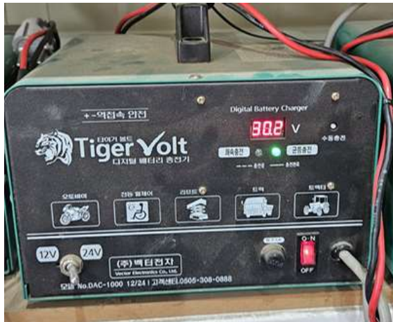
충전종료전압 - 업체 충전기 30.2V, 실측 29.7V
