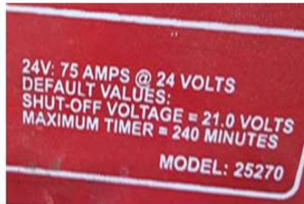
Lester社 12V/24V 75A 방전기 [24V 방전중지전압 - 21.0V]
