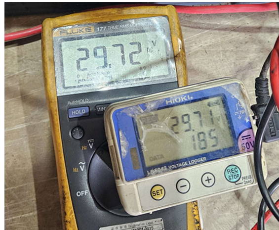
충전종료전압 - 업체 충전기 30.2V, 실측 29.7V
