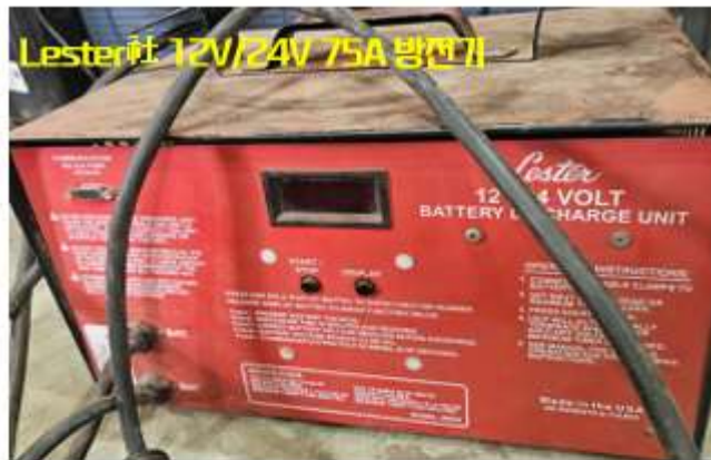
Lester社 12V/24V 75A 방전기 [24V 방전중지전압 - 21.0V]
